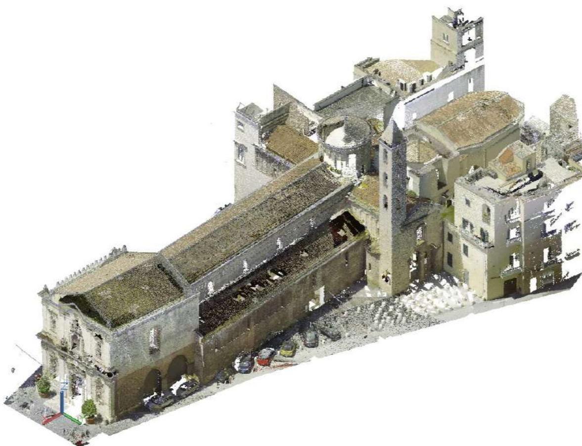
Figura 19 - Cattedrale di San Cataldo - rilievo laser scanner - assonometria
